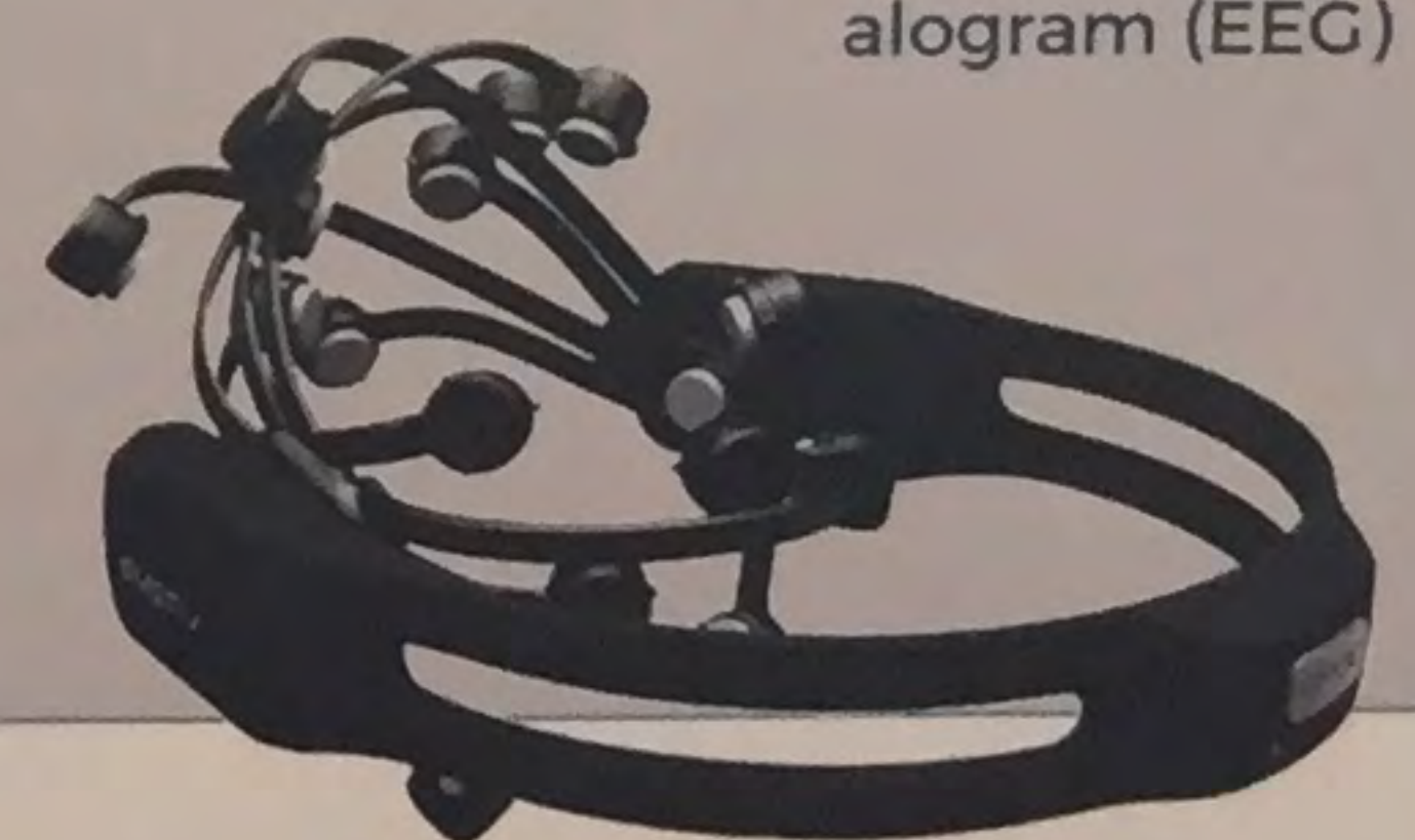
*EMOTIV EPOC+ Portable Electroencephalogram (EEG)
